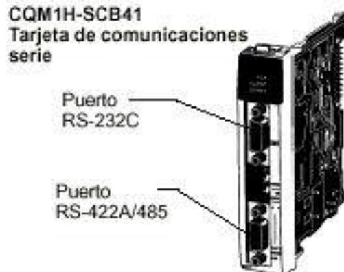
La Tarjeta Opcional CQM1H-SCB41 se trata de otra de las nuevas tarjetas opcionales que se pueden utilizar con el CQM1H-CPU51/61, que puede ser instalada, únicamente, en el slot 1 (slot izquierdo) de la CPU. Esta tarjeta no puede ser instalada en el slot 2 (slot derecho). Esta tarjeta tiene dos puertos serie de comunicaciones, de esta forma se puede incrementar fácilmente el número de puertos del CQM1H.
