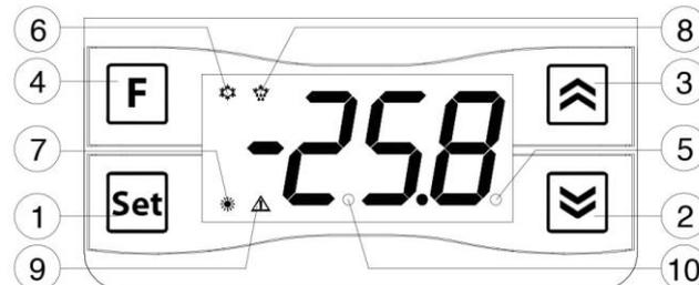
**1 - TECLA "SET":** Pulsando y soltando, programación del valor de regulación (Set Point). Manteniendo durante 5 segundos, entrada al menú configuración.
